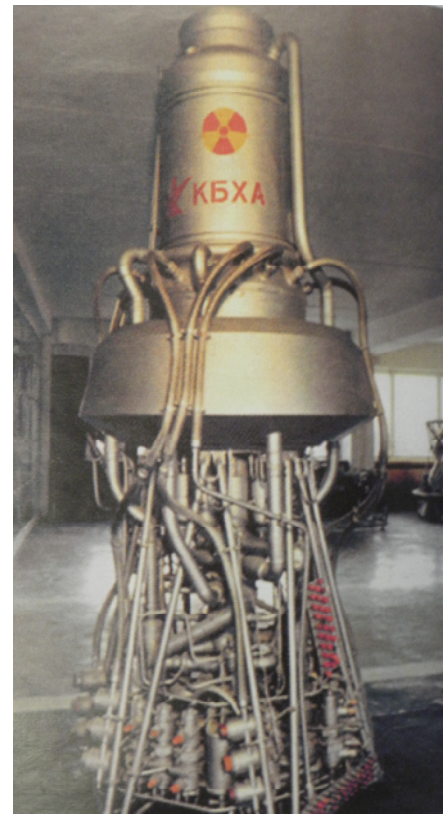
核エネルギー装置（天頂ロケットシステム）（設計グループ長 イゴリ・ボンダルチェンコ）。1970年10月に、初めて宇宙に発射された。
