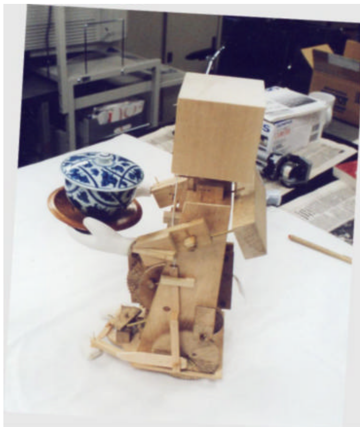
写真 1 8 茶碗を両手に持って前に進んでいる。足用クランクと首振り用クランクの配置の様子がよく見える。左柱の中間に、首振り用クランクの支え板が張り付けられている。2つのクランクは、二の輪に差し込まれた一本の丸棒に、二の輪の回転と共に自由に動けるようにはまっている。二の輪の1回転毎に、足と首を前後に一度振ることになる。
