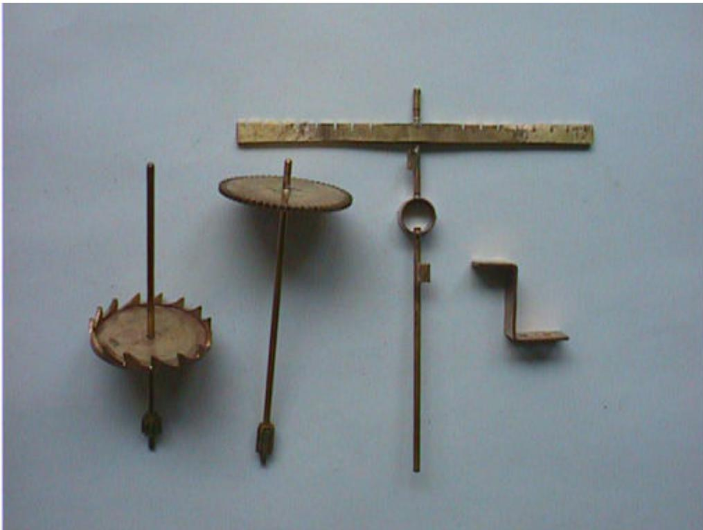
写真2 行司輪、二の輪、天符とその吊り台
