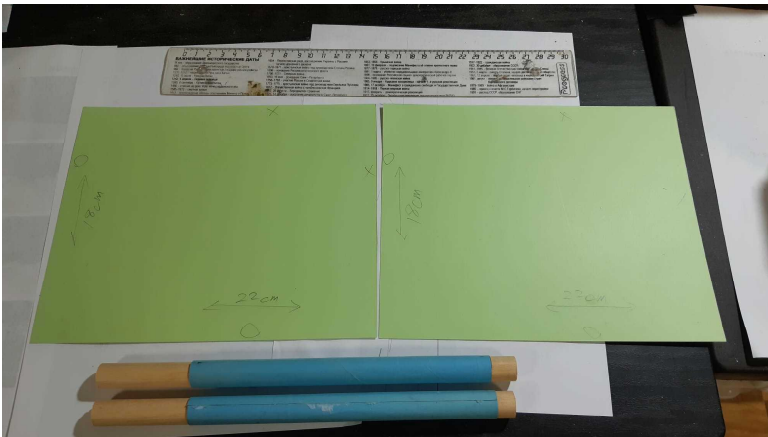
写真2 引合棒の作成。厚さ0.2mm、幅18cmで、長さは内径16mmで3巻～4巻の筒に仕上げるための長さ分とする。下の2本の棒は外径16mmとした型棒。これに上の紙を巻き付け、筒を作る。
