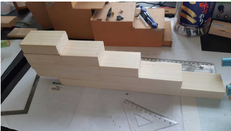
写真8 上方の茶色の物は文献(1)の 檀。これでは上手く連理棒が回転しな かった。いろいろと檀の形状も変え、そ 中で組み上げた中央の白っぽい檀が試 験用の最良檀である。段差2.5cm、幅 5cm、奥行き8cm。段差2cmでは 調子が良くない、2.5cmとした。引 合棒の両端を10mmほど長くしたので、 段差を大きくすると、引合棒の端が 檀に引っかかる場合があり、調子が 良くない。人形の身長は制限されて いるので思い切って、檀の幅を狭く し5cmとした。連理棒が回転時に 檀にぶつからないようにするために。
