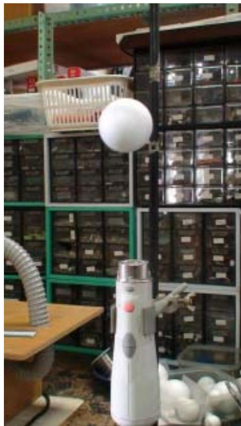
写真2 垂直気流による球の安定浮遊
