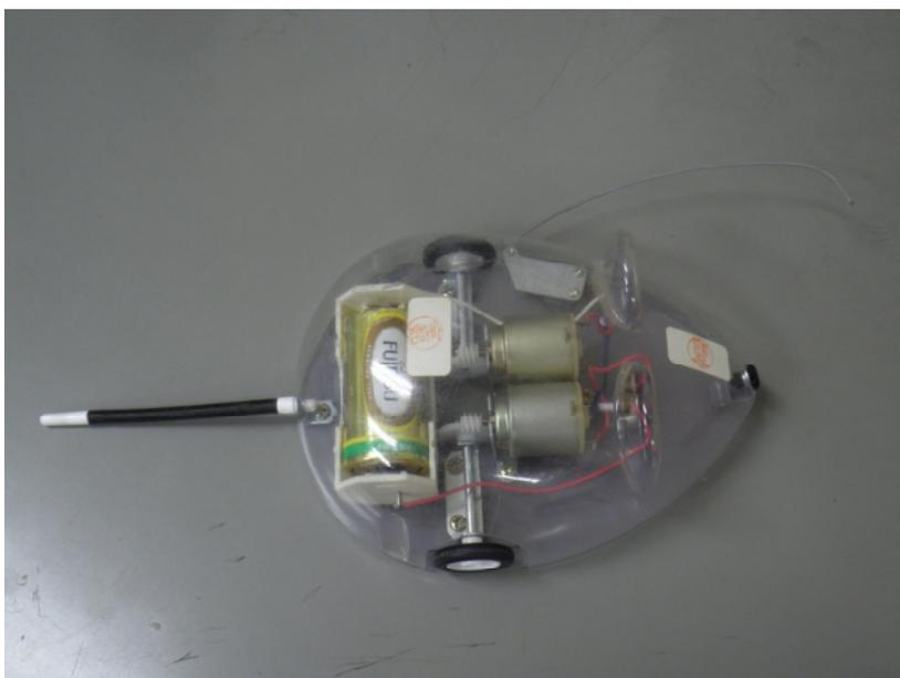
写真1 見本とした「壁伝いネズミロボット」
