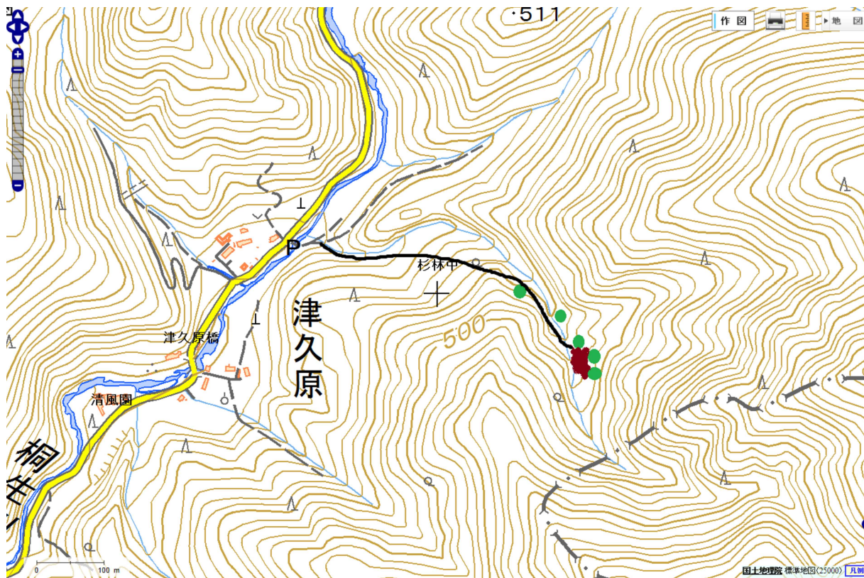
図2 図1の部分の拡大図に相当。Pが駐車場。沢に沿った黒細線が山道。黄緑丸が坑口跡。茶ベタがズリ。
