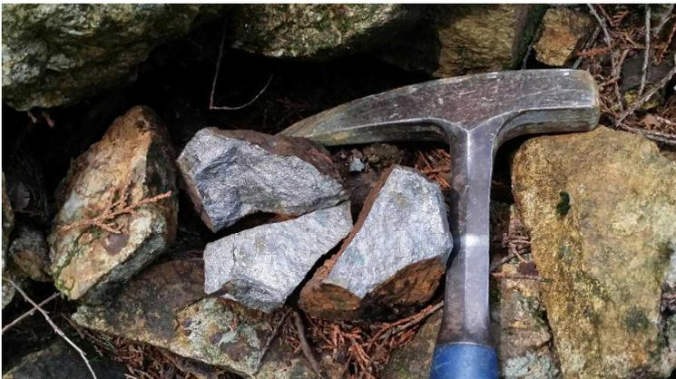
写真9 最初のプラト一部の上流付近で採集した、100%磁硫鉄鉱の標本。表面が赤さびていて、かつ重そうな石をハンマーで一撃。銀ピカだらけの破断面が眩しかった。
