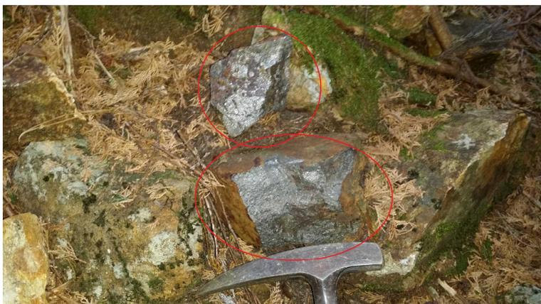
追写真2 今回も採取した磁硫鉄鉱。劈開面全体が銀色に輝いている。赤丸がハンマー一撃で割れてできた双子の兄弟。
