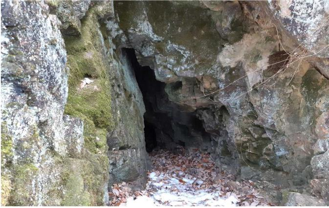
追写真7 沢のさらに上部の左側にあった坑口跡。露頭脈に沿って上方に斜面を切り開いたようである。
