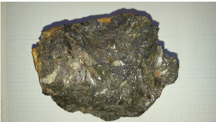
写真6 採集したヘデンベルグ石（灰鉄輝石、 $\text{CaFeSi}_2\text{O}_6$ ）。大きさ横12cm×縦12cm
