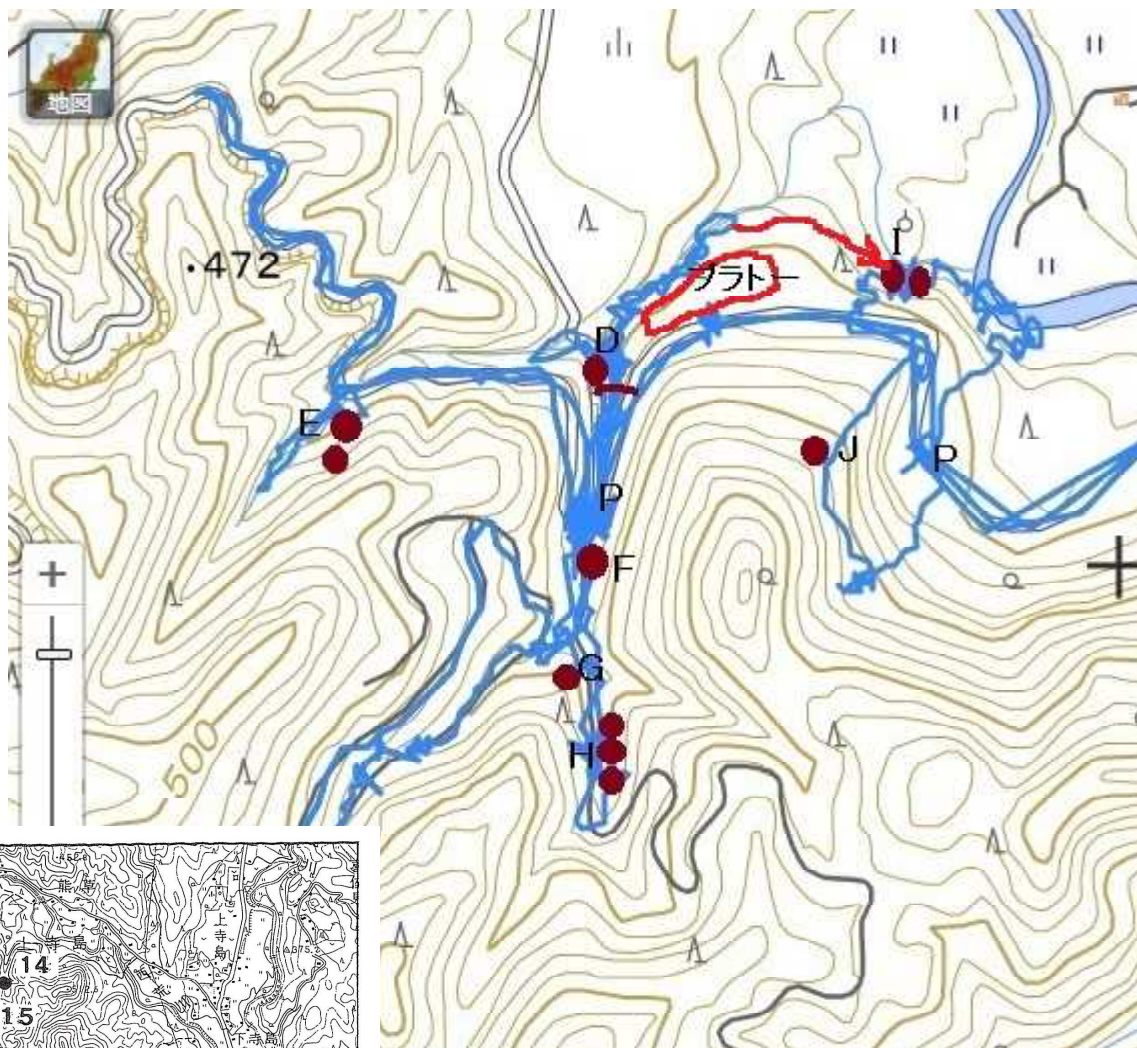
図3 図2の部分拡大図。林道のP点が駐車場所。文字DからJの付近で多くの坑口跡を確認した。茶丸が坑口跡。D点付近には沢と林道の間に広いプラトーがある。鉱山施設跡と思われる。D点付近の坑口付近の沢床に沢を横切るような鉱石は薄いが露頭鉱脈を確認。それを茶線分で示している。ここでなら確実に銅鉱石を採取できよう。なを、何度にも渡る探査による経路ログを重ね書きしている。結果として「無駄」な経路ログもあることに留意すること。
