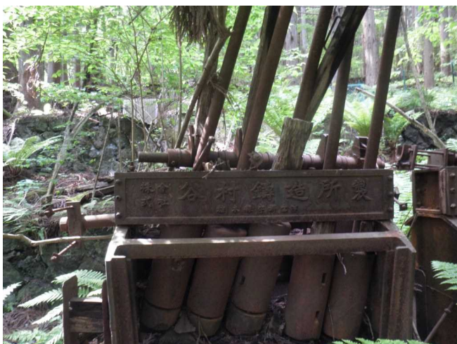
写真2 鉱山跡にあった鉱石粉碎器。周りには何段もの石垣組がある。
