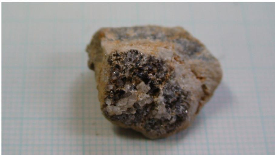
中央部の半透明の微結晶は石英と水晶、その周りの黒色の微結晶が錫石
