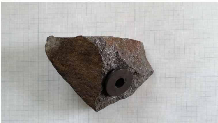
写真9 転石として採集した磁鉄鉱。文具用リング型フェライト磁石が張り付いている。
