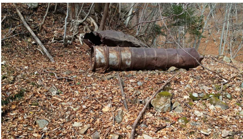
写真4 同上。金属製円形のローラーである。回して選鉱したのであろう。トロッコ用レールもある。
