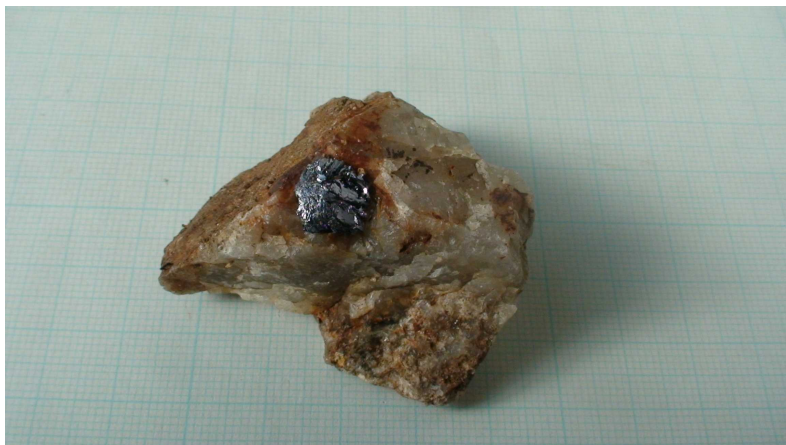
母岩の石英の左右長は5 cm。銀色の丸いものが輝水鉛鉱。厚み3 mm。
