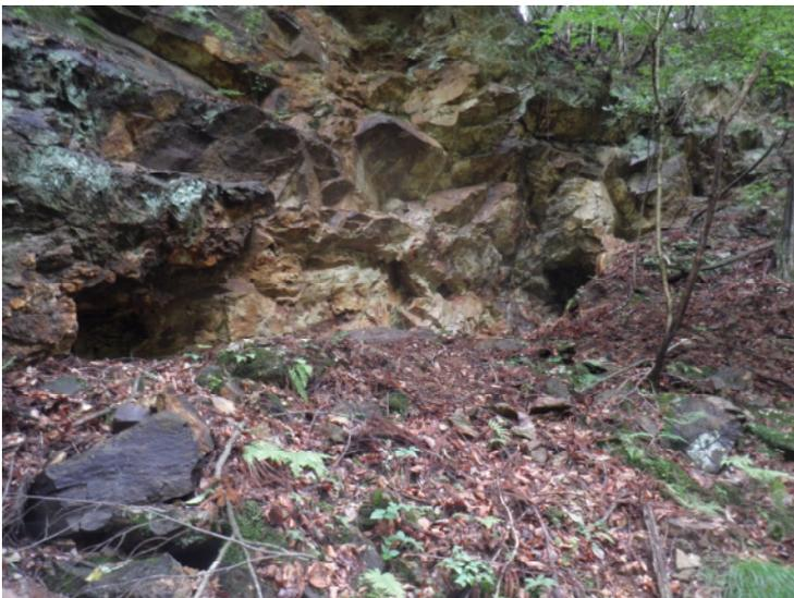
写真4 沢の右岸上部にある坑口跡である。写真では左右2箇所に坑口跡が見えるが、あたりには幾つもの坑口跡がある。手前はズリである。正面の岸壁には、表面が錆びた輝安鉱がこびり付いていた。
