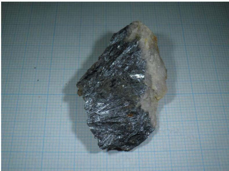
写真7 写真6の標本の家族。輝安鉱らしく、銀ピカの剣の束の様子がよく見える。
