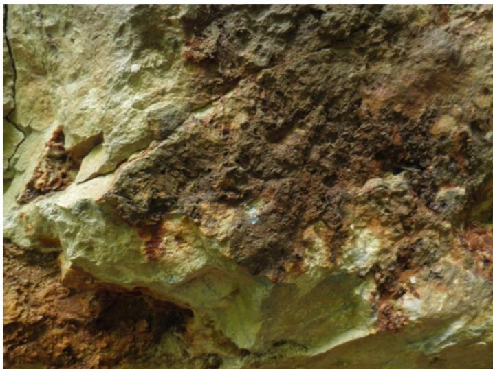
写真5 茶グロのこびりつきをハンマーで叩いたら、銀白色の劈開面が出てきた。中央、茶色の中の銀色の部分。駈け落ちた試料をESCAで調べたら、Sb（アンチモン）とS（硫黄）の線が出た。
