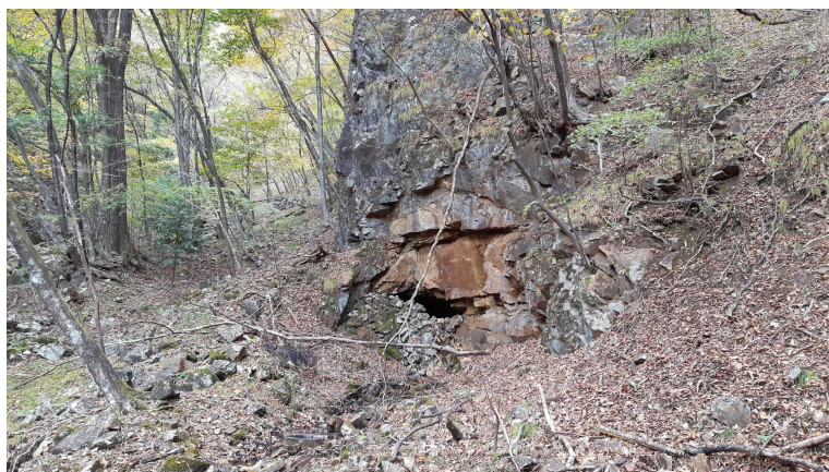
写真3 D点付近。垂直岸壁下部に坑口跡。中央部の黒い部分。鉱山図の図3にはこの坑口の記号はない。
