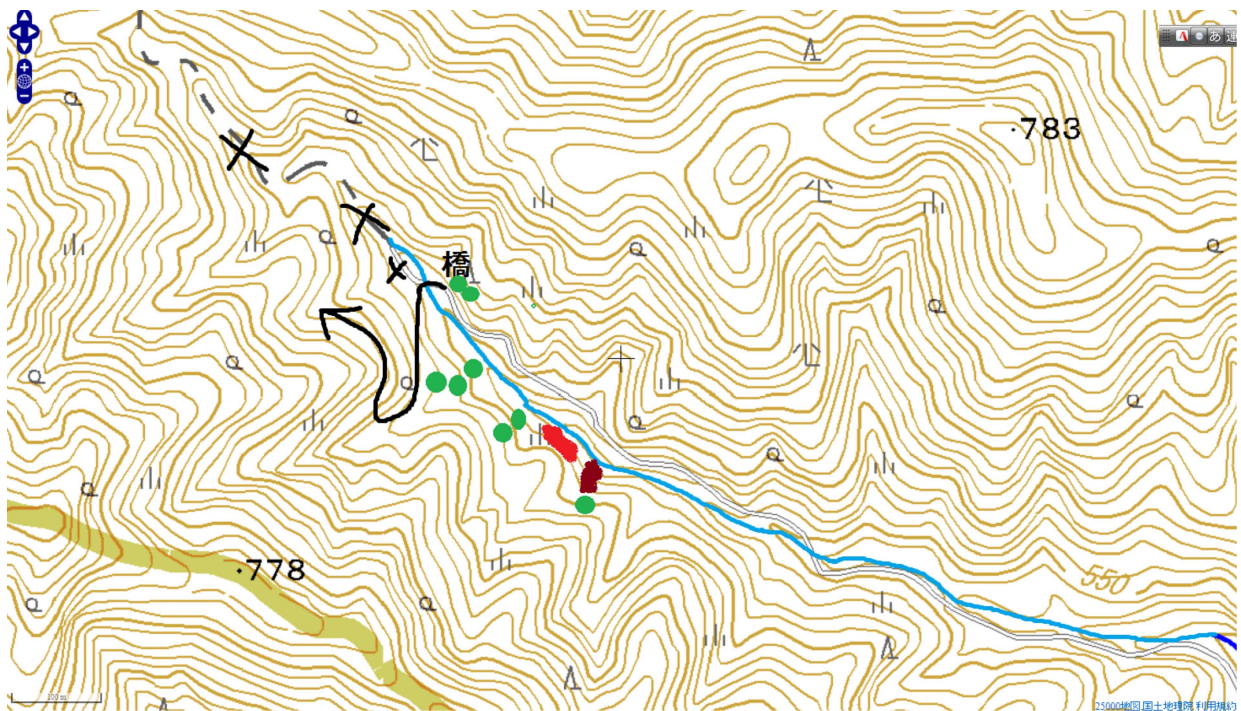
図2 図1の拡大図。参考にした現在の地形図には沢水が描かれていないので、水色の曲線で沢水を書き入れた。橋の所から、地形図中の林道は消滅している。×印を付けている。黒曲線で描いた少し新しい林道が、尾根の上まで伸びている。黄緑丸が坑口跡。幾つもあった。赤ベタがプラト一部であり、鉱山施設跡と思われるが？ 茶色ベタがズリ跡。その付近の沢で、黒くて大きい転石を割った。良いマンガン鉱の標本を採集することができた。
