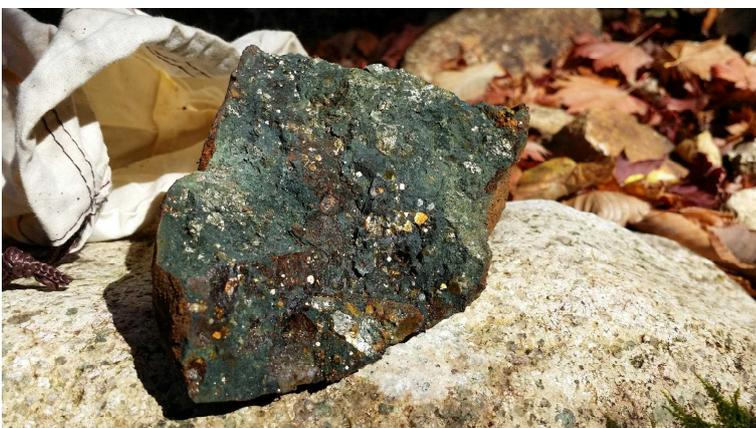
写真9 Aの坑口跡で採集した標本。黄鉄鉦粒が散在している。
