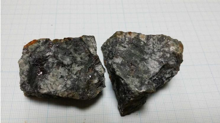
写真10 Bの坑口跡のプラトーで採集した標本。方鉛鉱に富んでいる。
