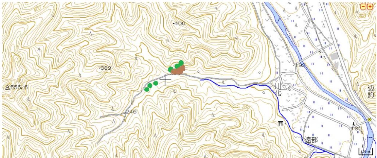
図2 図1の部分拡大図。鉦山跡は踏切より約1.2km。林道を挟んで2カ所にある。その間の距離は約100m。緑丸が坑口跡、茶色ベタがズリ。共に多数の坑口があり、マンガン鉦脈に沿って掘られたものようである。
