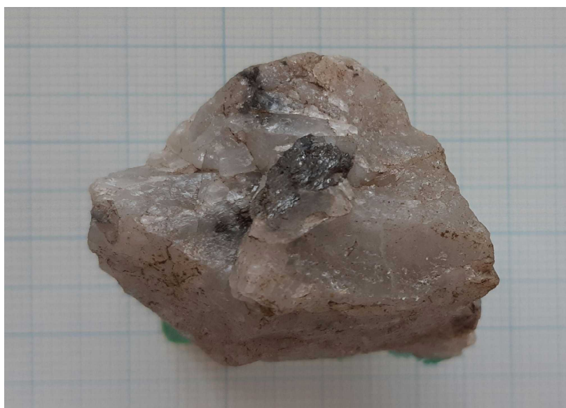
写真 1 9 中央の黒い部分が、石英の母岩中に成長した鉄マンガン重石。 B 点の砂防ダム下の坑口跡当たりで表面採集で見つけた物。
