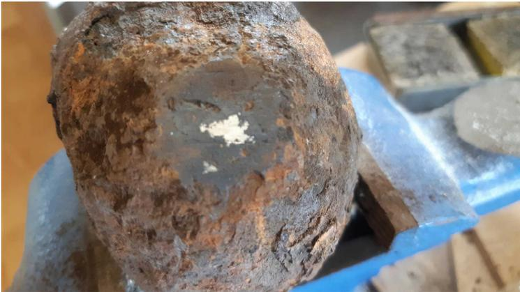
写真14 ハンマーでは全く割れなかったもので、帰宅後、ヤスリで表面を少し削った。銀色に輝く部分が露出してきた。磁石は確りつく。今のところ、銅鉄合金の塊と考えている。孔雀石、緑青が全く見えていないのが気になるが。
