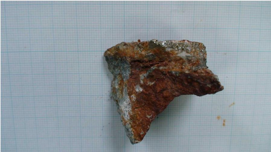
上の部分に 5 mm 厚の黄銅鉱の平らな塊がこびり付いている。
