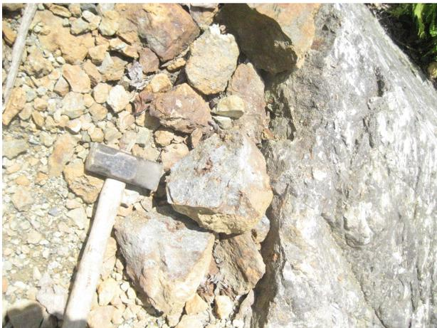
上記のズリで適当な石をハンマーで叩いた。割れ目一面に微細な黄銅鉦が母岩と共に分布していた。片方を標本として採集した。このズリ跡では、現在でも結構な標本を採集することができよう。
