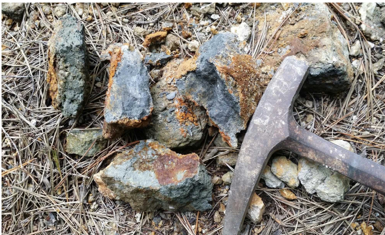
写真 1 4 衛生坑跡のズリから集めた鉱染状の鉱石、重晶石の一葉。標本は豊富である。
