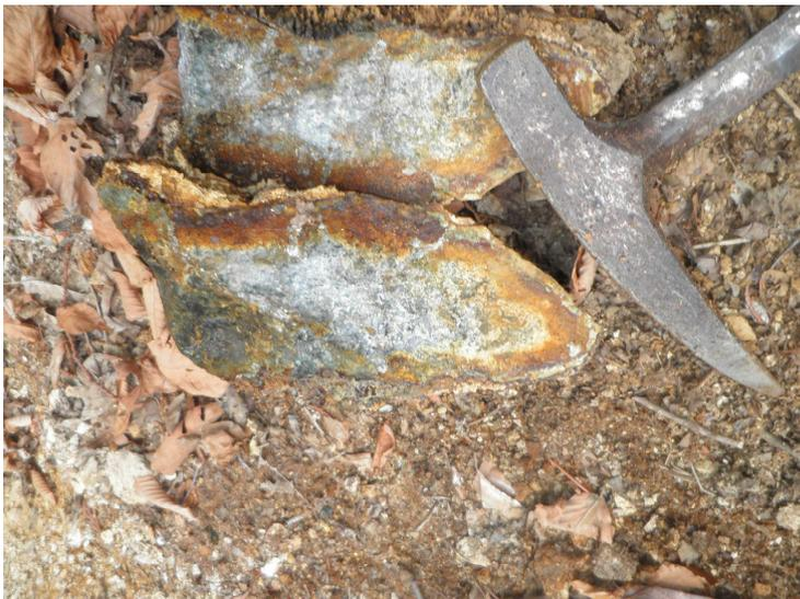
写真11 ズリから取り出した大きめの石を破断。鉱染状の破断面が見える。黄銅鉱、黄鉄鉱、閃亜鉛鉱の微結晶が散らばっていた。写真に撮っただけ。
