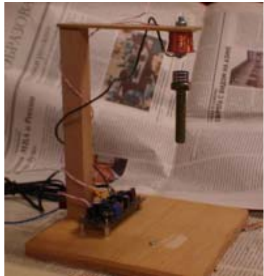
写真2 再構築した磁気浮遊装置
