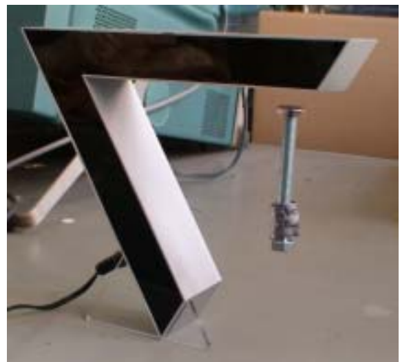
写真4 ネオ磁石+細いボルト+鉛板の錘
