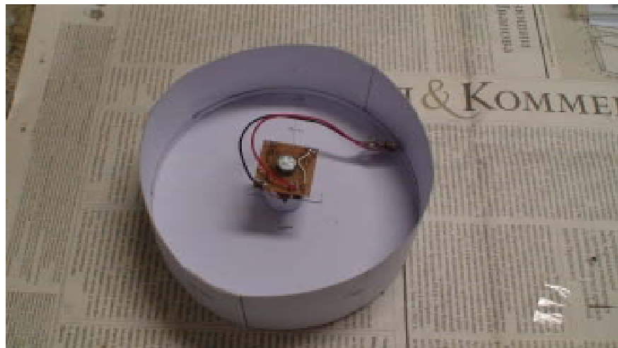
写真 1 2 ソレノイドを取り付けた回転皿を台に納め、裏から見た様子
