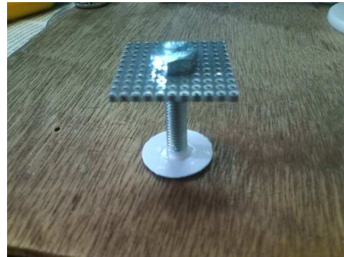
写真9. ソレノイド部のコイル巻きつけ部
