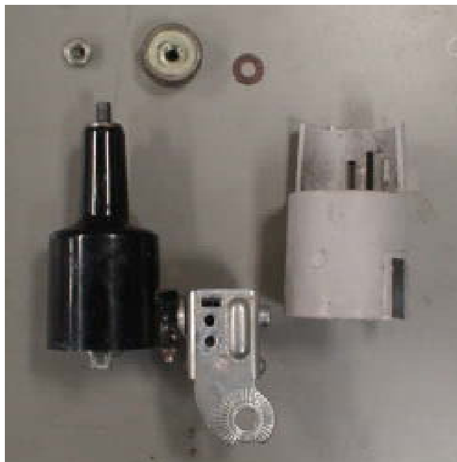
写真2 カバ - 部と回転輪を取り外す
