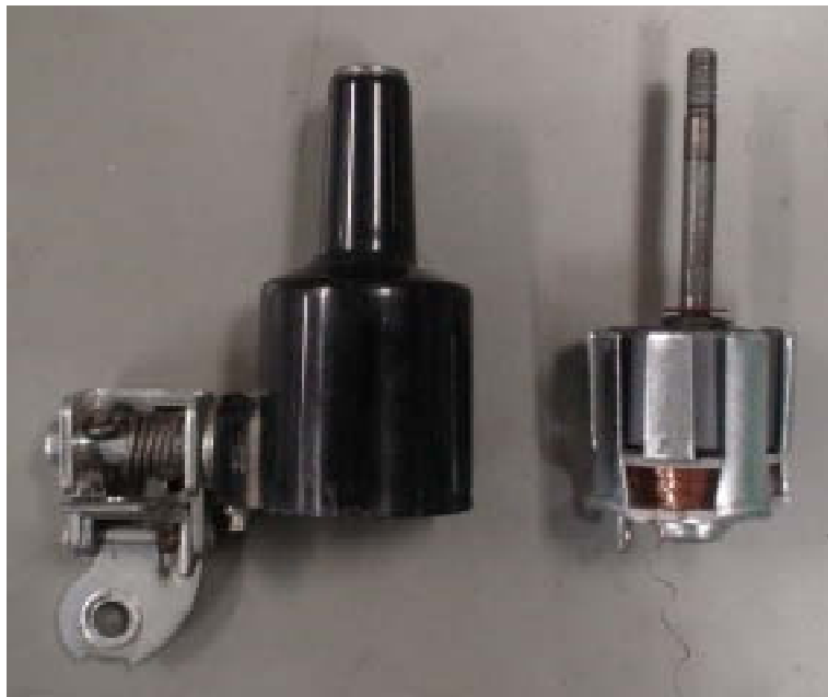
写真4 発電部の取り外し
