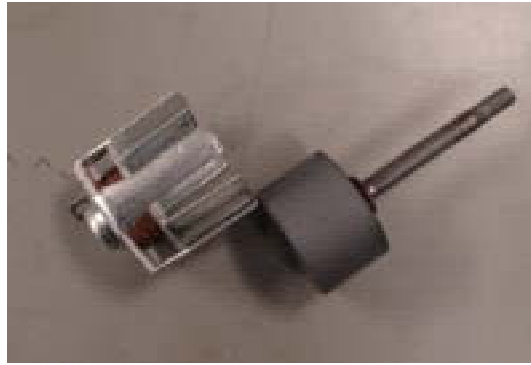
写真7 ソレノイド部と磁石部は接続はしていない
