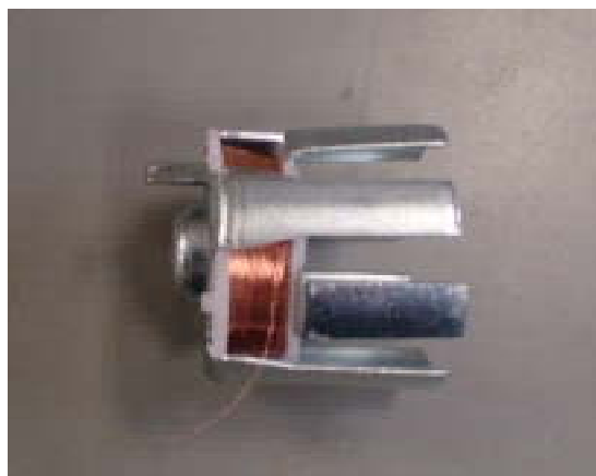
写真10 新しいコイルを巻いて組み立て
