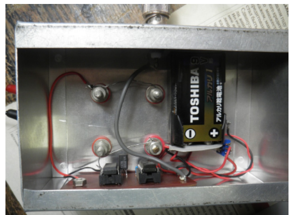
付録写真1、2 LC共振発生回路の外様と内様
