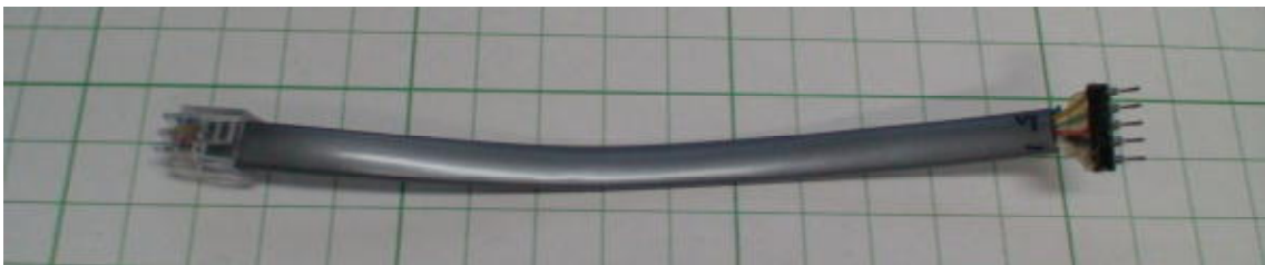
図6、末端を加工したICSPケーブルの全体写真
